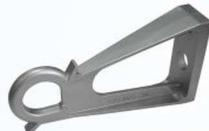
Применяется для крепления поддерживающих зажимов. Кронштейн изготовлен из алюминиевого сплава и имеет максимальную разрушающую нагрузку 6 кН. Конструкция кронштейна позволяет крепить его к опоре двумя стальными лентами со скрепами или к стене болтом.
