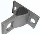
Применяется для крепления одного или двух анкерных зажимов. Изготавливается из алюминиевого сплава устойчивого к коррозии. Кронштейн имеет максимальную разрушающую нагрузку 20 кН. Конструкция кронштейна позволяет крепить его к опоре двумя стальными лентами со скрепами или двумя болтами к стенам зданий.
