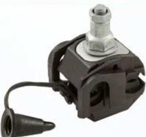
Зажимы применяются для герметичного соединения и ответвления фазных и нулевых жил самонесущих изолированных проводов и проводов абонентских ответвлений СИП-2 и СИП-4. В процессе затяжки болта со срывающей головкой, зубцы контактных пластин прокалывают изоляцию и входят в зацепление с проводником, образуют надежный контакт с минимальным переходным сопротивлением. Корпус зажима выполнен из механически прочного термопластика армированного стекловолокном.
