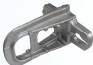
Применяется для одинарного или двойного крепления анкерных зажимов. Кронштейн имеет максимальную разрушающую нагрузку 15 кН. Кронштейн крепится к фасаду или при помощи болтов. Изготовлен из коррозионно-стойкого стального или алюминиевого сплава большой механической прочности.
