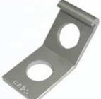
Применяется для крепления анкерных зажимов абонентских ответвлений СИП от магистрали к вводам. Конструкция кронштейна позволяет крепить его стальной лентой или болтом. Кронштейн выполнен из стойкого к коррозии алюминиевого сплава и имеет максимальную разрушающую нагрузку 2 кН.
